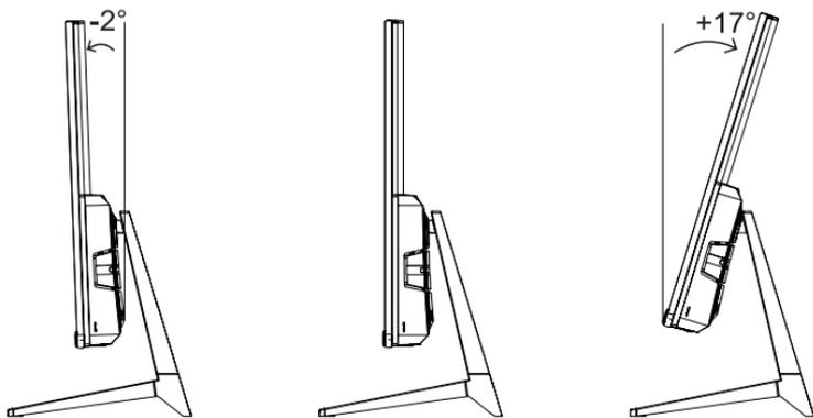
Coloque el monitor de pie y ajuste el ángulo de inclinación del monitor según sea necesario.
