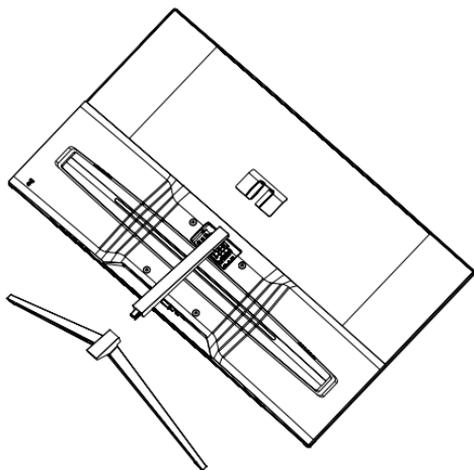
Saque el soporte, alinéelo con la interfaz de la parte posterior de la pantalla, inserte cuatro tornillos y apriételos con un destornillador; inserte la interfaz de la base en el soporte, inserte un tornillo y apriételo; por último, coloque la cubierta de plástico decorativa y fíjela.
